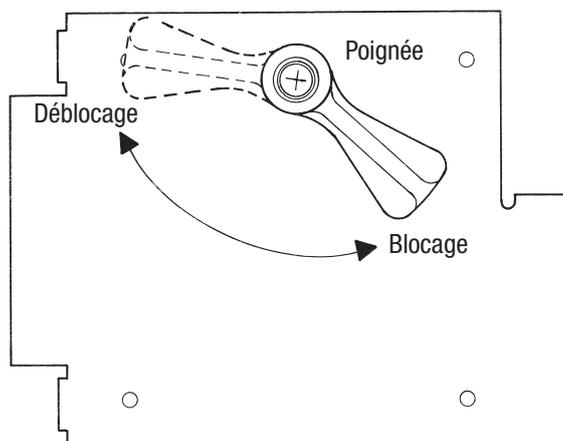
En cas de coupure d'électricité ou de pannes, débloquez le motoréducteur en utilisant la poignée prédisposée.
