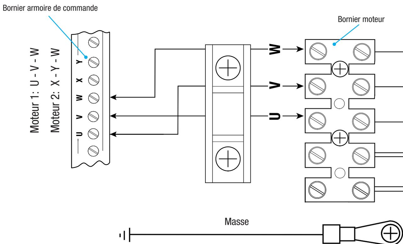
☞ En cas d'utilisation d'un seul moteur (portail à un vantail), le connecter à W X Y (M2) indépendamment du côté de montage.
