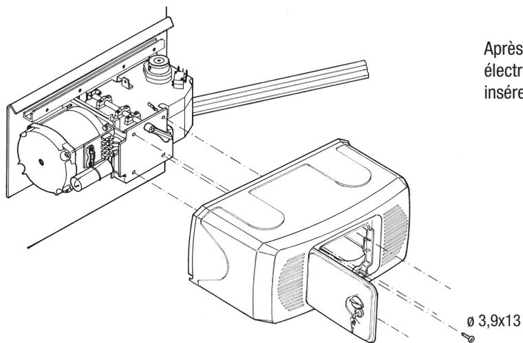
Après avoir terminé les opérations de montage, les connexions électriques et les réglages, bloquez de nouveau le moteur et insérez le couvercle en le fixant avec les quatre vis fournies.
