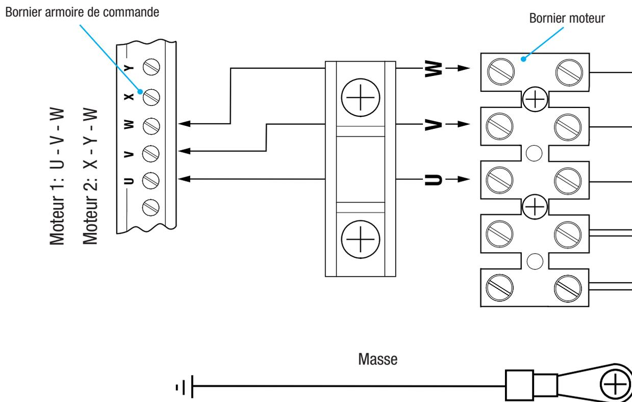
☞ En cas d'utilisation d'un seul moteur (portail à un vantail), le connecter à W X Y (M2) indépendamment du côté de montage.
